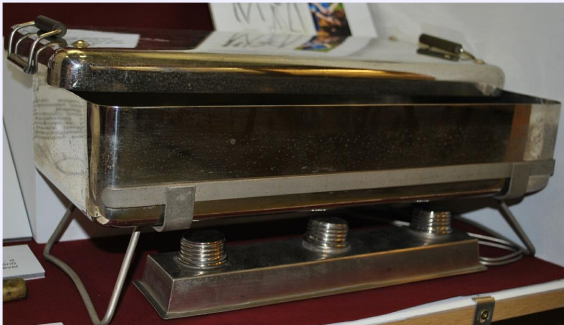
Az eszközök fertőtlenítésére szolgáló, borszesz égővel működő autokláv (A Sebészeti és szemészeti tanszék ajándéka)
